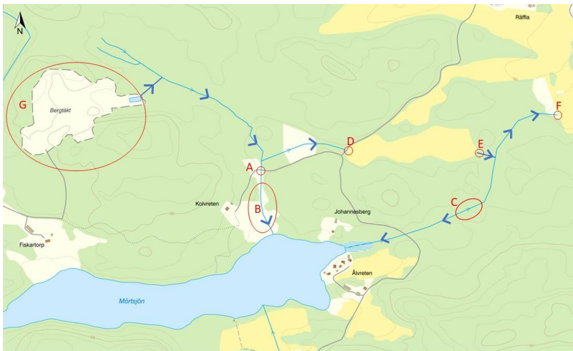
Figur 2. Flödesvägar östra delen av området. Diken och flödesriktningspilar i mörkblått avser i fält observerade faktiska förhållanden. Lägen för dessa diken är ungefärliga, deras funktion ur flödesavseende är dock verifierad i fält.
